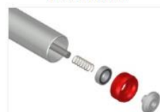
RODILLO UNIVERSAL RETRACTIL VISTA EXPLOSIONADA
